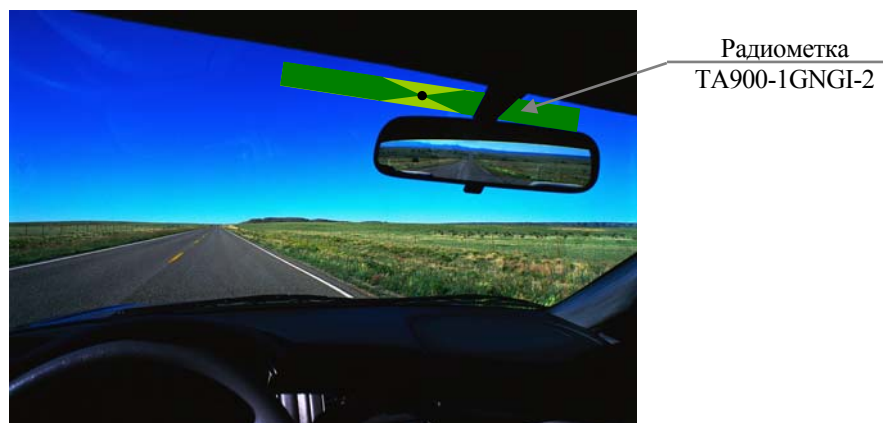
Рис. 3. Размещение радиометки на лобовом стекле автомобиля.
